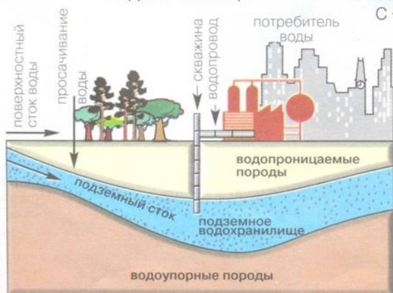
ОБРАЗОВАНИЕ ПОДЗЕМНОГО ВОДОХРАНИЛИЩА
